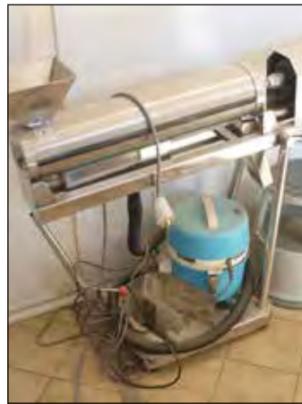
Nettoyeuse de gélules : polish mesh capsules
